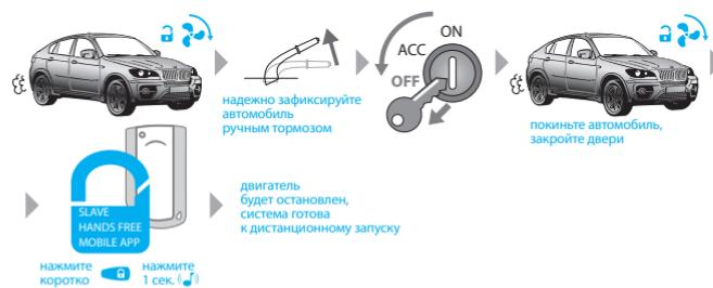
В случае если предполагается использовать дистанционный или автоматический запуск двигателя на автомобиле с МКПП, то перед постановкой автомобиля на охрану необходимо выполнить следующую последовательность действий:
